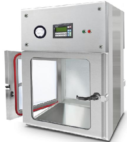
**S.A.S. Esclusa** para el paso de productos entre distintas salas sin variación de presión ni de temperatura y posibilidad de esterilización del producto. Fabricado con cámara intermedia aislante en las cuatro caras, con canto redondeado en su interior para facilitar la limpieza. Posibilidad de incorporar bandeja intermedia desmontable.
