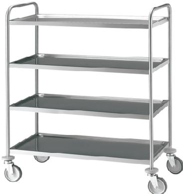
**CARRO DE SERVICIO** contruidos en acero inoxidable AISI 304. Estantes muy robustos por su profunda embutición y plegado especial. Estructura totalmente soldada con 4 ruedas giratorias de 125 Ø con parachoques. Capacidad máxima de carga por estante 75 Kg. con un máximo total de 200 Kg. Acabado vibrado fino y satinado.
