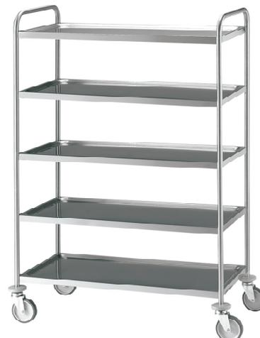
**CARRO DE SERVICIO** contruidos en acero inoxidable AISI 304. Estantes muy robustos por su profunda embutición y plegado especial. Estructura totalmente soldada con 4 ruedas giratorias de 125 Ø con parachoques. Capacidad máxima de carga por estante 75 Kg. con un máximo total de 200 Kg. Acabado vibrado fino y satinado.
