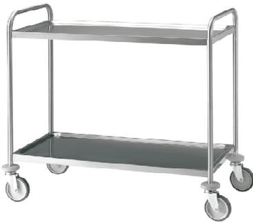
**CARRO DE SERVICIO** contruidos en acero inoxidable AISI 304. Estantes muy robustos por su profunda embutición y plegado especial. Estructura totalmente soldada con 4 ruedas giratorias de 125 Ø con parachoques. Capacidad máxima de carga por estante 75 Kg. con un máximo total de 200 Kg. Acabado vibrado fino y satinado.
