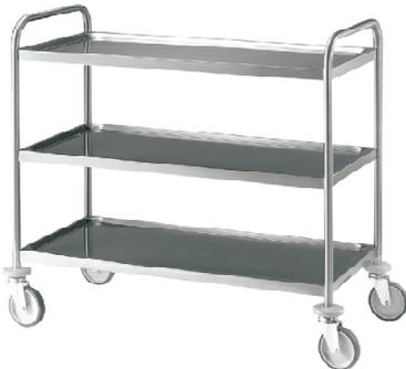
**CARRO DE SERVICIO** contruidos en acero inoxidable AISI 304. Estantes muy robustos por su profunda embutición y plegado especial. Estructura totalmente soldada con 4 ruedas giratorias de 125 Ø con parachoques. Capacidad máxima de carga por estante 75 Kg. con un máximo total de 200 Kg. Acabado vibrado fino y satinado.
