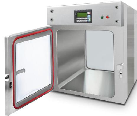
**S.A.S. Esclusa** para el paso de productos entre distinta salas sin variación de presión y temperatura, posibilidad de esterilización del producto. Fabricado con cámara intermedia aislante en las cuatro caras, con canto redondeado en su interior para facilitar la limpieza. Posibilidad de incorporar bandeja intermedia desmontable.
